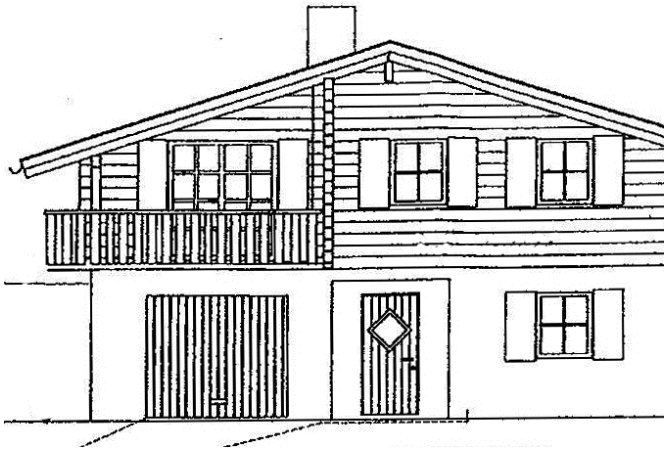
Das Originalhaus erhielt an der Wetterseite eine Zusatzdämmung mit Schindelverkleidung
